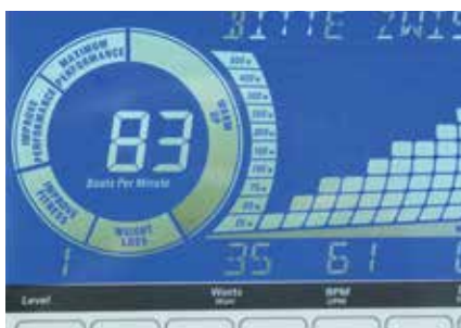
Das HR WHEEL ordnet den Puls in anschaulicher Art und Weise eine der verschiedenen Pulszonen zu.
